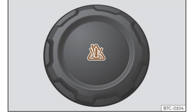
الشكل 37. المقصورة الأمامية: غطاء خزان التوسيع الخاص بسمائل التبريد.
