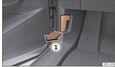
الشكل. 34 حرر الذراع الموجود عند موضع قدم السائق.
