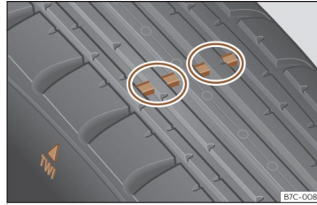
الشكل. 41 مجموعة خصائص الإطار : مؤشرات تآكل المداست.
