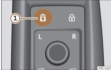
الشكل. 23 في باب السائق: المس اللوحة الخاصة بقفل الأطفال الكهربائي.
