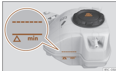
איור 37 בתא הקדמי: מיכל התפשטות נוזל קירור.
