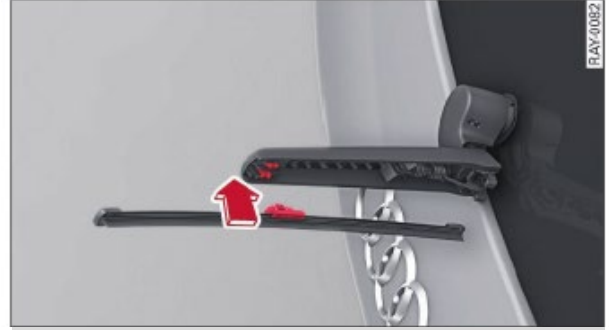
الرسم 3 - مساحة الزجاج الخلفي: تركيب شفرة المساحة
