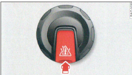
איור 199 Unlock תא מנוע: לחצן שחרור נעילת מכל האיזון של נזל הקירור
