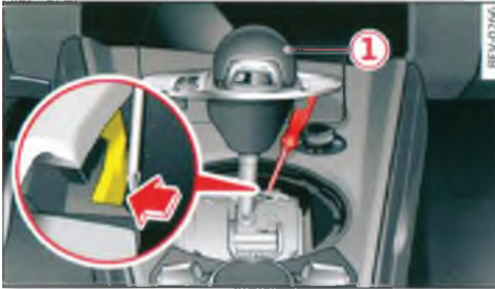
رسم 85 ذراع ناقل الحركة: التحرير في حالة الطوارئ، والإخراج من الوضعية P.
