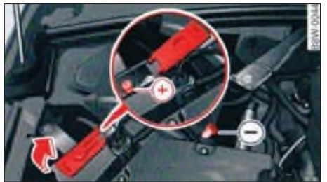
איור 352 תא מנוע: חיבורים להתקן הטענה וכבלי התנעה
