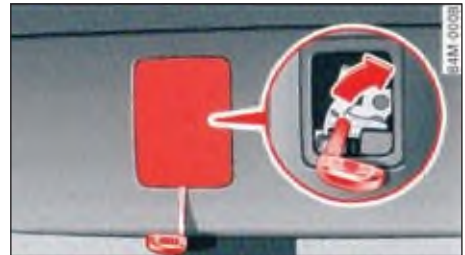
الصورة ٣٨ واجهة باب صندوق السيارة: ممر تحرير إقفال الطوارئ
