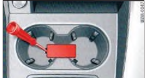
איור 119 מחזיק משקאות קדמי: הסרת הכיסוי
