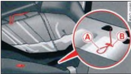
الصورة ٣٧ المقعد الخلفي: كابل باودن لتحرير الطوارئ
