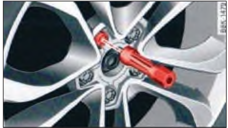
الصورة ٣٥٠ العجل: مفتاح سداسي لتحريك براغي العجل
