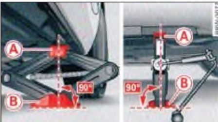
الصورة ٣٤٩ سقف أسفل: وضع المرفاع
