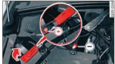
الصورة ٣٥٢ غطاء المحرك: وصلات لجهاز الشحن وكابلات التشغيل
