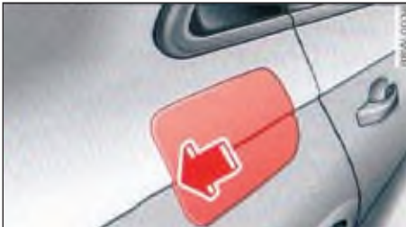
الصورة ٣٢٠ الجهة اليمنى الخلفية من السيارة: فتح باب فتحة خزان الوقود
