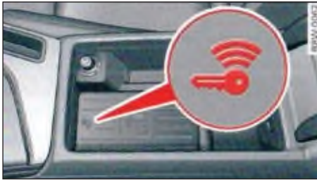
الصورة ١١٠ وحدة التشغيل المركزية/مفتاح لاسلكي لتشغيل المحرك في حالة حدوث عطل
