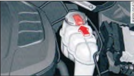
الصورة ٢٣٠ Unlock غرفة المحرك: زر تحرير قفل حاوية توازن سائل التبريد
