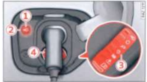
الصورة 76 جانب الراكب: منفذ شحن السيارة والزر/مؤشر الشحن
