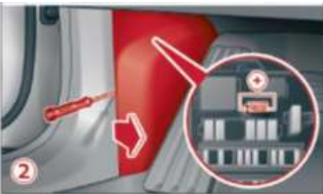
איור 154 הסר כיסויים: הצד הקדמי של תא הטייס שמאל ① או תא הרגל ②
