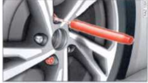
الصورة 168 عجلة المفتاح السداسي لتحرير براغي العجل
