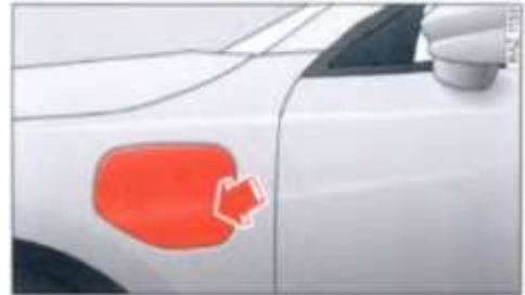
איור 75 צד קדמי של הרכב משמאל: לפתוח את מכסה טעינת המתח הגבוה
