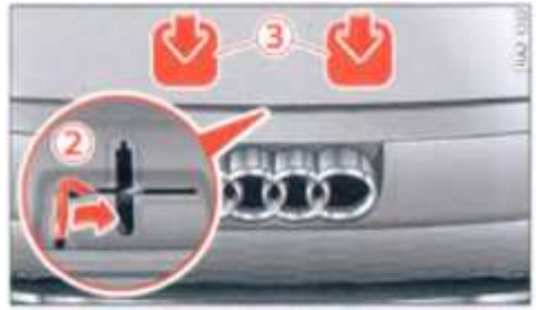
الصورة 150 غطاء المحرك الأمامي مقفل: ② رافعات للفتح. ③ نقاط ضغط للإغلاق
