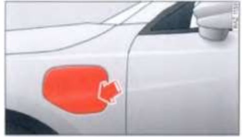
الصورة 75 جانب أمامي للسيارة من اليسار: لفتح غطاء شحن الفولتية العالية
