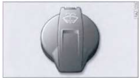
איור 157 שטח קדמי: כיסוי למיכל כביסה
