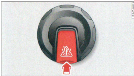
איור 199 Unlock תא מנוע: לחצן שחרור נעילת מכל האיזון של נוזל הקירור
