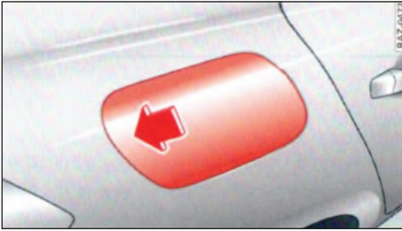
الصورة ١٢٤ الجانب الأيمن الخلفي من السيارة: فتح غطاء خزان الوقود
