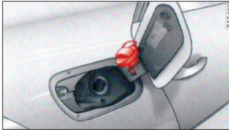
الصورة ١٢٥ باب خزان الوقود مع غطاء وقود متصل
