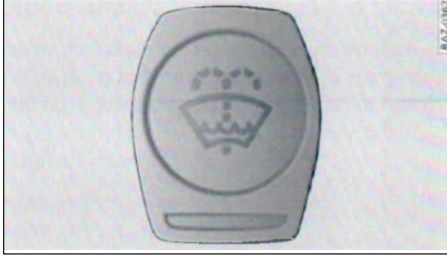
الصورة ١٣٦ غطاء محرك: غطاء خزان سائل الرشاش
