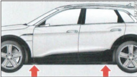
الصورة ١٩٣ عتبات الباب: علامات
