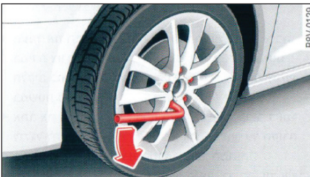
איור 329 שחרור בורגי הגלגל
