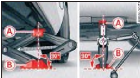
الصورة ٣٤٩ سقف أسفل: وضع المرفاع
