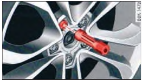
الصورة ٣٥٠ العجل: مفتاح سداسي لتحريك براغي العجل
