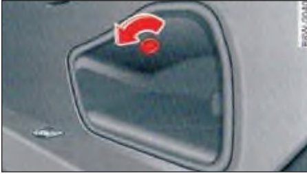
الصورة ٣٢٢ فتح الغطاء الجانبي لصندوق السيارة
