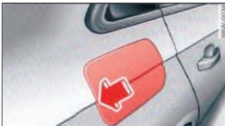
الصورة ٣٢٠ الجهة اليمنى الخلفية من السيارة: فتح باب فتحة خزان الوقود
