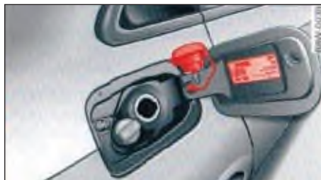
الصورة ٣٢١ باب خزان الوقود مع غطاء وقود متصل
