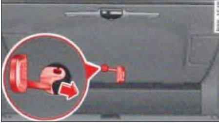
الصورة ٣٦ واجهة باب صندوق السيارة: ممر تحرير إقفال الطوارئ
