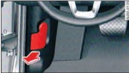
איור 326 שחרור מכסה תא המנוע מתבצע מתוך הרכב.
