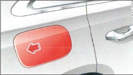
الصورة 189 الجهة اليمنى الخلفية من السيارة: فتح باب حاوية الوقود
