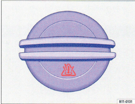
الصورة 194 في غطاء المحرك: غطاء حاوية سائل تبريد المحرك.
