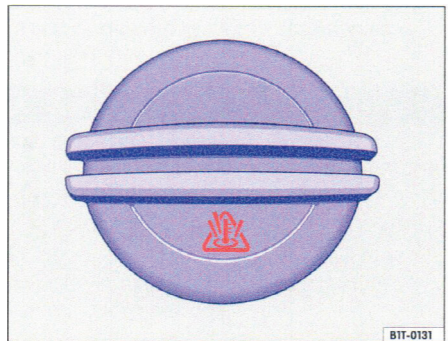
אויור 194 בתא המנוע: מכסה מיכל הנוזל לקירור המנוע.
