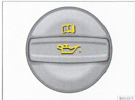
الصورة 150 في غطاء المحرك: غطاء فتحة تعبئة زيت المحرك (صورة بيانية عامة).
