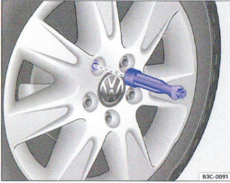
الصورة 246 تبديل العجل: تحرير براغي العجل بواسطة مفاتيح العجلات
