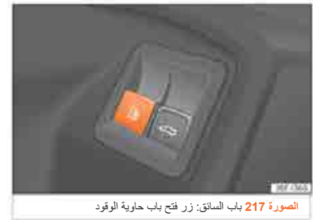
الصورة 217 باب السائق: زر فتح باب حاوية الوقود
