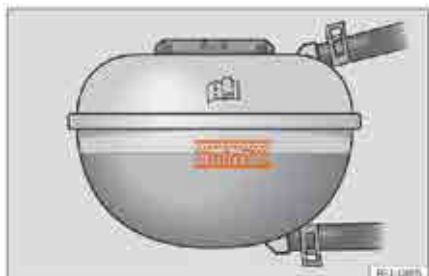
איור 226 בתא המנוע: סימון על מיכל התפשטות של נוזל הקירור.
