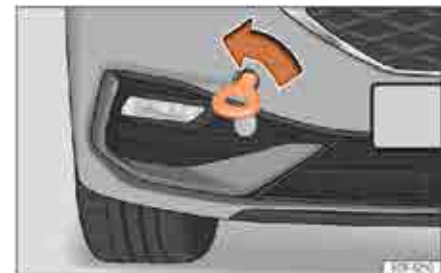
الصورة 52 الجانب الأيمن للمصد الأمامي: تثبيت حلقة الجر
