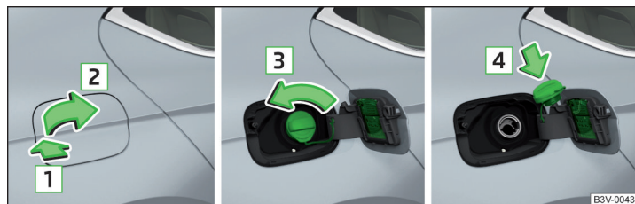
الرسم ٢٥٩ فتحة خزان الوقود / إزالة غطاء خزان الوقود / تركيب غطاء خزان الوقود
