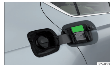
איור 258 מדבקה עם מפרט סוגי דלק
