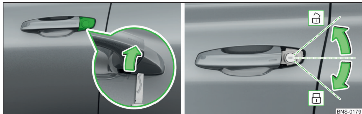
איור 303 ידית דלת הנהג: פתיחת כיסוי המנעול / נעילה ושחרור נעילה
