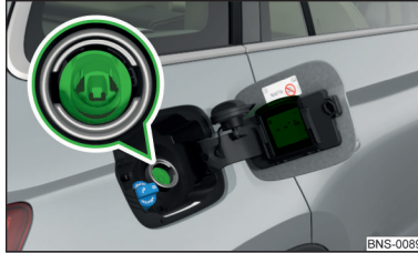
الصورة ٢٧٢ فتحة خزان الوقود في السيارات المزودة بمحركات ديزل
