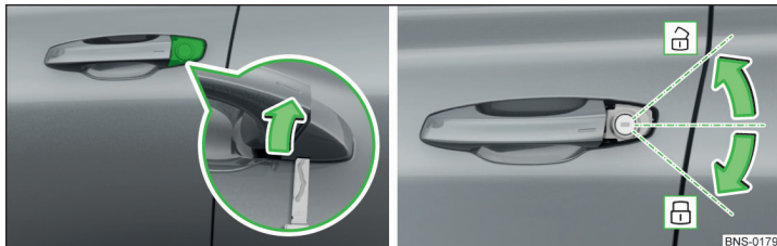
الصورة ٣٠٣ مقبض باب السائق: فتح غطاء القفل/إقفال وتحرير القفل
