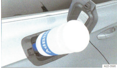
الصورة 188 خلف فتحة تعبئة خزان الوقود: تعبئة السائل AdBlue® بواسطة قارورة التعبئة (مخطط عام).
