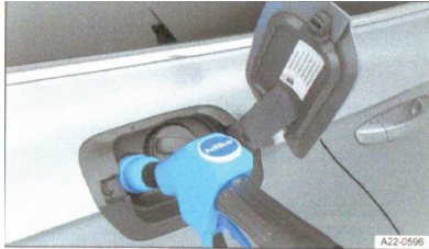
الصورة 189 خلف فتحة تعبئة خزان الوقود: تعبئة السائل AdBlue® بواسطة مضخة التعبئة (مخطط عام).
