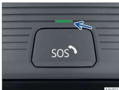
איור 46 בקונסולת התקרה: רכיב הפעלה עבור מערכת שיחת החירום הדרושה בחוק eCall (מאחורי כיסוי הלחצנים) ונורית חיווי.
