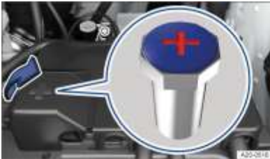
الصورة 191 في المقصورة الأمامية أسفل الغطاء: نقطة التشغيل بالكابلات، موجب.
