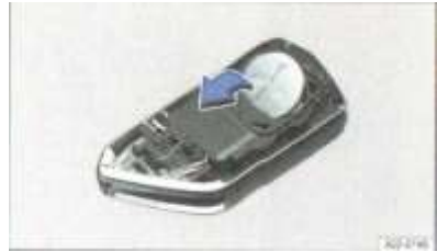
الصورة 51 مفتاح السيارة: تبدال بطارية الزر.
