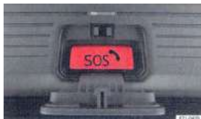
איור 47 בקונסולת התקרה: לחצן עבור מערכת שיחת החירום הדרושה בחוק eCall.
