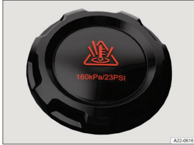
الصورة 186 في المقصورة الأمامية: غطاء حاوية سائل التبريد (رسم عام).
