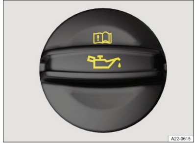
الصورة 184 في المقصورة الأمامية: غطاء فتحة تعبئة زيت المحرك (رسم عام).
