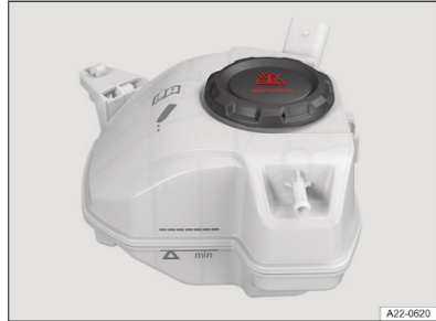
الصورة 187 في المقصورة الأمامية: علامات على حاوية سائل التبريد (رسم عام).
