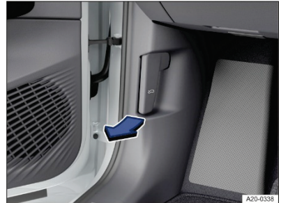
איור 176 באזור הרגליים בצד הנהג: ידית לפתיחת המכסה הקדמי (תרשים כללי).
