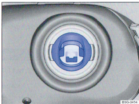
איור 232 תרשים כללי: מגן מפני תדלוק שגוי בפתח המילוי.
