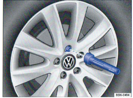
الصورة 284 تبديل العجل: تحرير براغي العجل بواسطة مفتاح العجلات.
