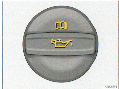
איור 234 בתא המנוע: מכסה פתח מילוי שמן המנוע (תרשים כללי).
