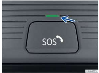
الصورة 45 في وحدة التشغيل بالسقف: مكون وعنصر التشغيل لنظام مكالمات الطوارئ المطلوب قانوناً eCall (خلف غطاء المفاتيح) ولمية التنبيه.
