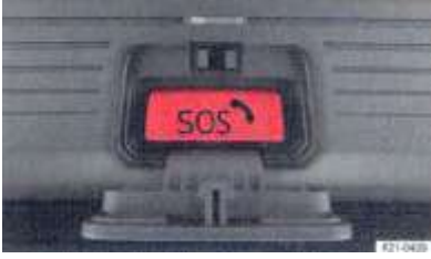
الصورة 46 في وحدة التشغيل بالسقف: زر خاص بنظام مكالمات الطوارئ المطلوب قانوناً eCall.
