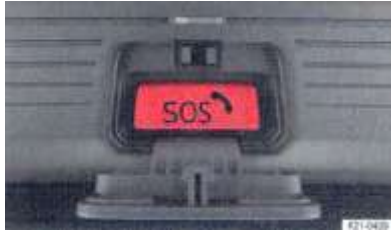
איור 46 בקונסולת התקרה: לחצן עבור מערכת שיחת החירום הדרושה בחוק eCall.
