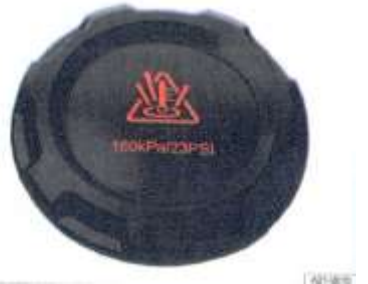
الصورة 192 في المقصورة الأمامية: غطاء حاوية الانتشار الخاصة بسائل تبريد المحرك (رسم تخطيطي عام).
