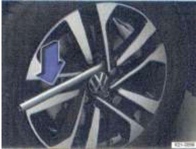
الصورة 208 تبدل العجل: تحرير براغي العجل بواسطة مفتاح العجلات
