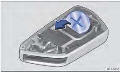
الصورة 50 مفتاح السيارة: تبديل بطارية الزر.
