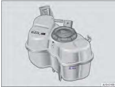
الصورة 193 في المقصورة الأمامية: علامات في حاوية تسريب سائل تبريد المحرك.
