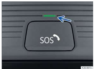
איור 45 בקונסולת התקרה: רכיב הפעלה עבור מערכת שיחת החירום הדרושה בחוק eCall (מאחורי כיסוי הלחצנים) ונורית חיווי.
