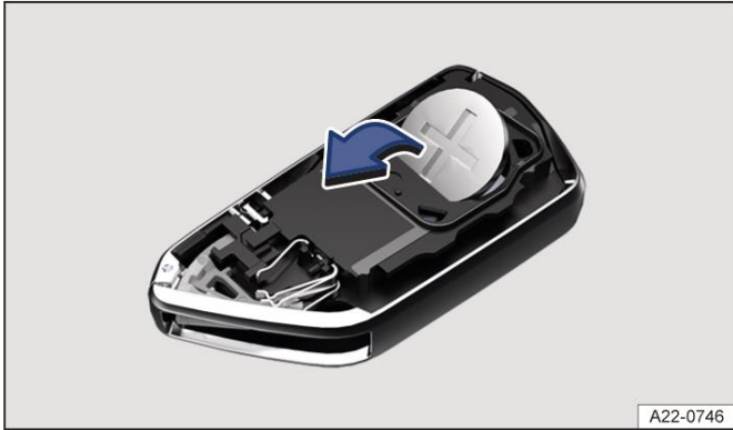
الصورة 2 مفتاح السيارة: تبديل بطارية الزر.
