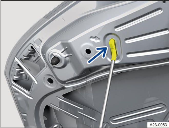
איור 4 במכסה המנוע: פתח עבור מוט התמיכה המתקפל.
