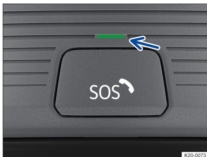
איור 1 בקונסולת התקרה: לחצן עבור מערכת שיחת החירום הדרושה בחוק eCall (מאחורי כיסוי הלחצנים) ונורית חיווי.
