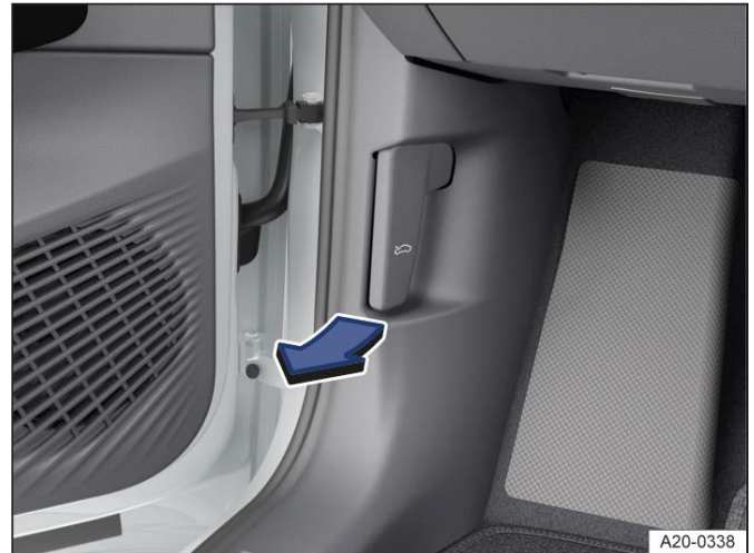
איור 1 באזור הרגליים בצד הנהג: ידית לפתיחת המכסה הקדמי (איור כללי).
