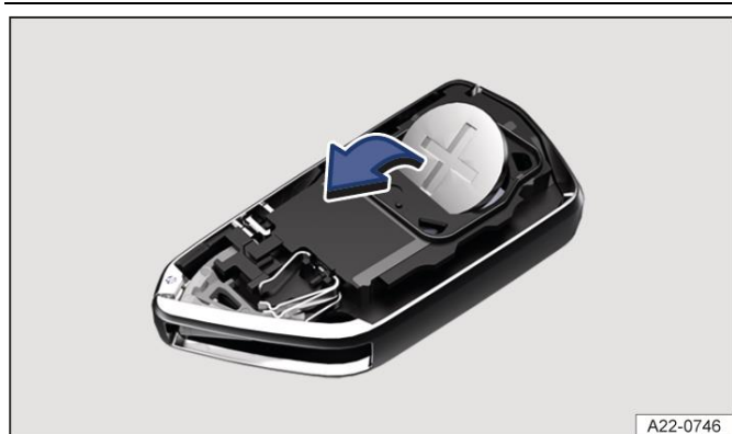
איור 2 מפתח הרכב: החלפת סוללת כפתור.
