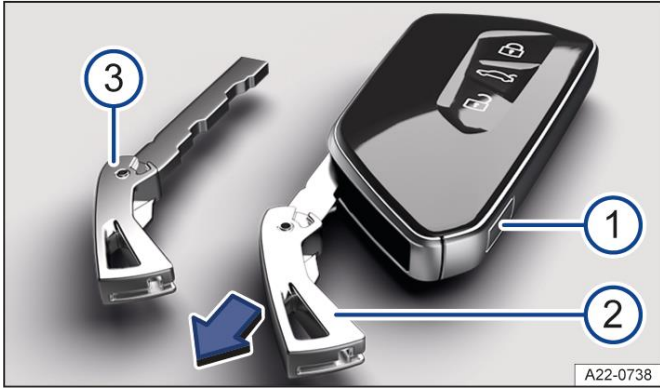
الصورة 1 مفتاح السيارة: تحرير قفل مفتاح الطوارئ.
