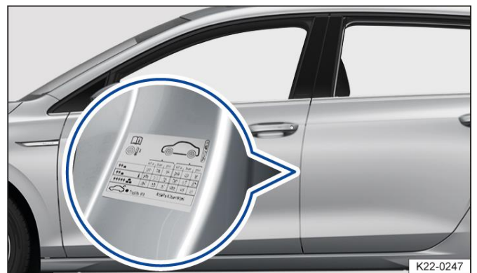
איור 1 על קורת דלת הנהג: מדבקת לחץ אוויר בצמיגים (לחלופין, על הצד הפנימי של דלתית המצבר).
