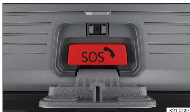
איור 2 בקונסולת התקרה: לחצן עבור מערכת שיחת החירום הדרושה בחוק eCall.
