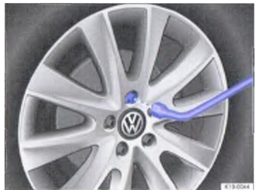
איור 196 החלפת גלגל: שחרור בורגי הגלגל באמצעות מפתח הגלגלים.
