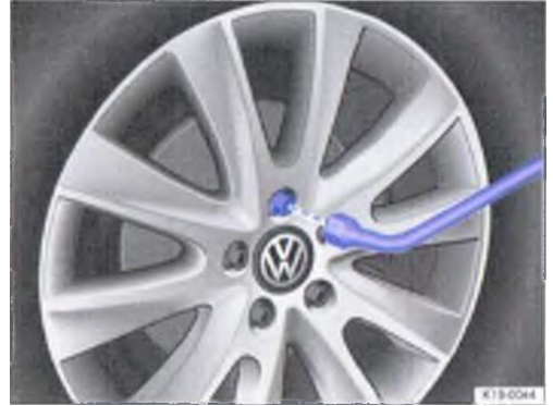
الصورة 196 تبديل العجل: تحرير براغي العجل بواسطة مفتاح العجلات
